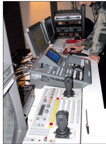
La regia della sala: in primo piano il pannello di controllo Panasonic e, sullo sfondo, i videoregistratori e streamer JVC
